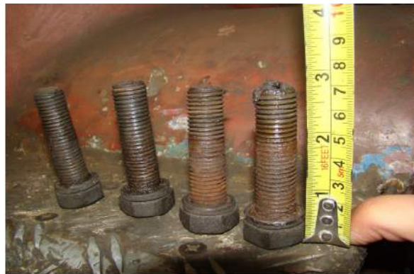
Șuruburile de fixare a legăturii de gardă osia 1 dreapta
