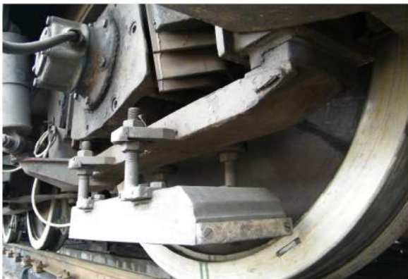
Modul de fixare a legăturii de gardă și inductorului de la post 1 osia 1 dreapta
