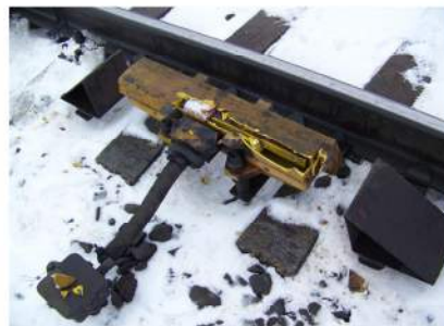
Inductorul 1000/2000 Hz aferent semnalului BI 14 lovit în urma incidentului feroviar
