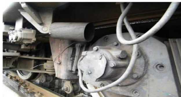
Osia 6 dreapta de unde a căzut legătura de gardă
